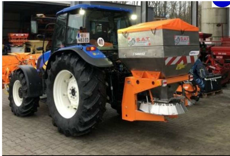
Só- és homokszóró gép
