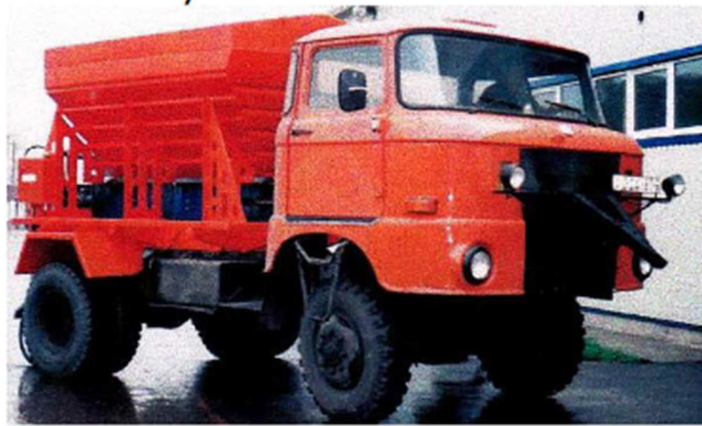
Só- és homokszóró gép
