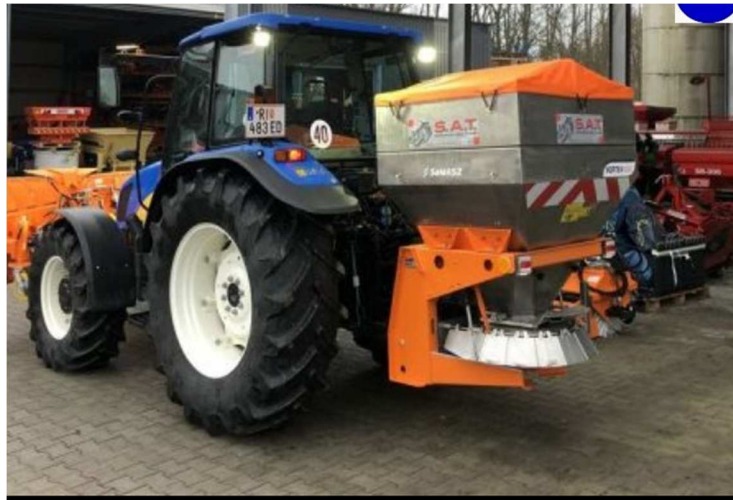
Só- és homokszóró gép
