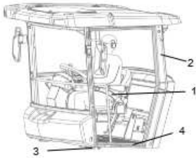
Ábra: Kezelőállás 1. Biztonsági öv 2. Bukócső (ROPS) 3. Gumielem 4. Csúszásgátló felület
